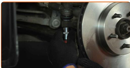
**92** Tratta con del prodotto l'elemento di fissaggio che collega la testina tirante al fuso a snodo. Usa il grasso al rame.
