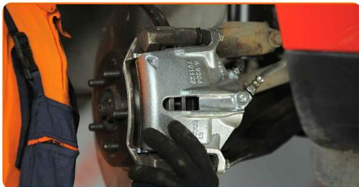
**88** Monta i bulloni di fissaggio (2 pezzi).
