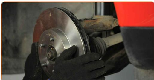
**86** Pulisci le sedi di montaggio della pinza e la sua staffa. Usa una spazzola metallica. Usa lo spray WD-40.
