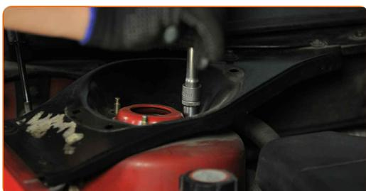
**61** Monta il coperchio di protezione del supporto di ammortizzazione.
