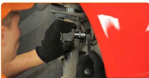
**30** Scollegare la staffa di fissaggio del tubo flessibile del freno.
