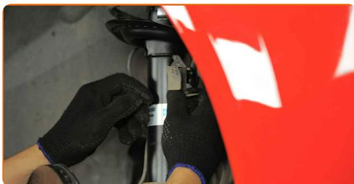
**94** Serrare la staffa di fissaggio del tubo flessibile freno sul supporto di ammortizzazione. Utilizza una chiave a bussola N°15. Usa una chiave dinamometrica. Serralo fino allo coppia di torsione di 31 Nm.
