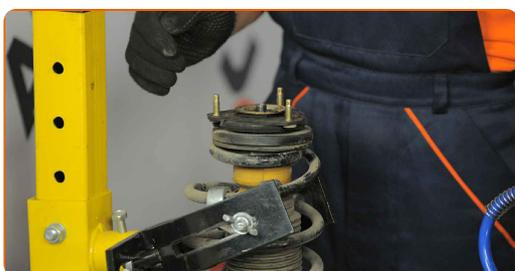
**55** Serrare la vite dell'asta pistone supporto ammortizzazione. Usa un giravite piatto. Utilizza una chiave a bussola N°18. Usa una chiave dinamometrica. Serralo fino allo coppia di torsione di 58 Nm.
