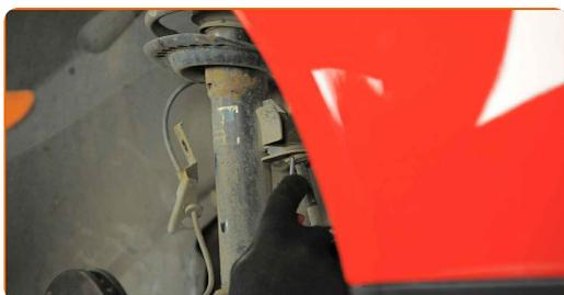
**31** Pulisci gli elementi di fissaggio che collegano il puntone dell'ammortizzatore al fuso a snodo. Usa una spazzola metallica. Usa lo spray WD-40.
