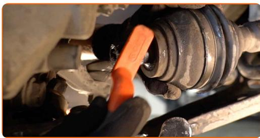
**73** Installa l'albero di trasmissione all'interno del mozzo della ruota.
