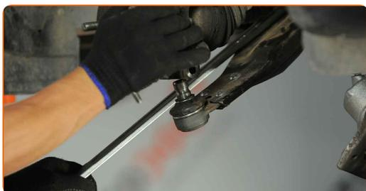
**75** Monta il bullone di fissaggio. Usa un martello.
