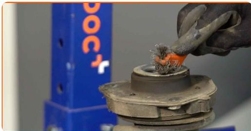
**45** Rimuovere il dado del montante del supporto di ammortizzazione. Usa un giravite piatto. Utilizza una chiave a bussola N°18. Usa una chiave a cricchetto.
