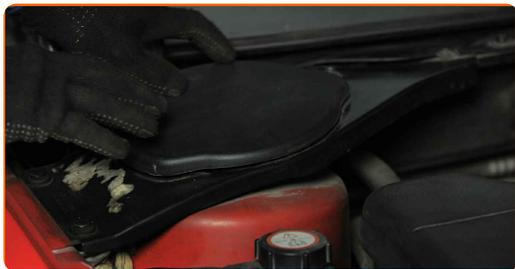
**62** Rimuovi la copertura di protezione del parafrango.
