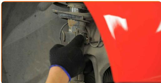
**29** Svitare la staffa di fissaggio del tubo flessibile freno dal supporto di ammortizzazione. Utilizza una chiave a bussola N°15. Usa una chiave a cricchetto.
