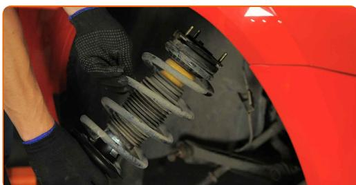
**59** Avvita l'elemento di fissaggio superiore del montante supporto ammortizzazione.
