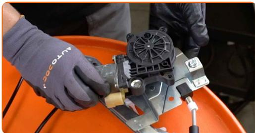
**26** Serrare gli elementi di fissaggio del modulo degli alzacrystalli elettrici. Usa la chiave Torx T30. Usa una chiave dinamometrica. Serralo fino allo coppia di torsione di 11 Nm.
