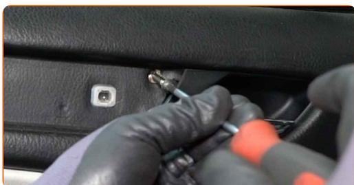
**8** Staccare il pannello interno della portiera. Usa un attrezzo di plastica per la rimozione finiture auto.
