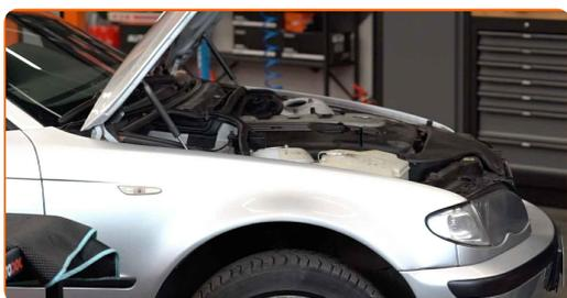
**2** Usa una copertura di protezione del parafrangente per evitare il danneggiamento della verniciatura e dei componenti in plastica dell'auto.
