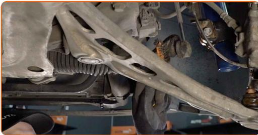
**9** Svita gli elementi di fissaggio che collegano il tirante della barra stabilizzatrice al puntone dell'ammortizzatore. Usa una chiave HEX N.H7. Utilizza una chiave combinata N°17. Usa una chiave a cricchetto.
