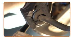
Pulisci le sedi di montaggio delle boccole dello stabilizzatore. Usa lo spray WD-40.
