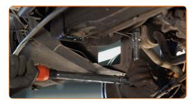
Tratta con del prodotto le staffe di supporto delle boccole dello stabilizzatore. Usa il grasso al rame. 14
