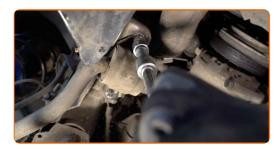
Rimuovi le staffe di supporto della boccola dello stabilizzatore.
