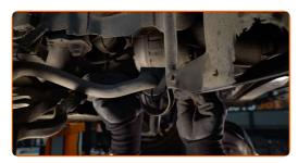
Avvita le staffe di supporto della boccola dello stabilizzatore. Utilizza una chiave a bussola N°16. Usa una chiave 13 dinamometrica. Serralo fino allo coppia di torsione di 28 Nm.
