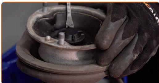
**23** Rimuovere il dado del montante del supporto di ammortizzazione. Utilizza una chiave a bussola N°22. Usa una chiave HEX N.H7.
