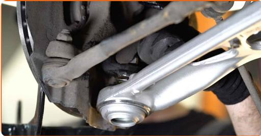
45 Rimuovi il supporto da sotto il fuso a snodo.
