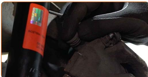
**23** Installare il sensore di usura sulle pastiglie dei freni. Usa delle pinze a becchi lunghi.
