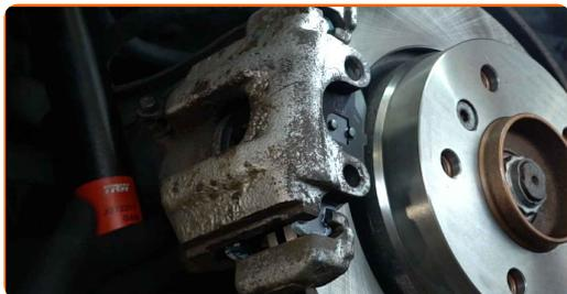
**20** Installare la molla di fissaggio della pinza freno.
