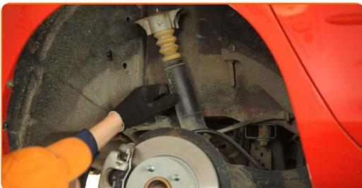
**14** Pulisci gli elementi di fissaggio del supporto superiore dell'ammortizzatore. Usa una spazzola metallica. Usa lo spray WD-40.
