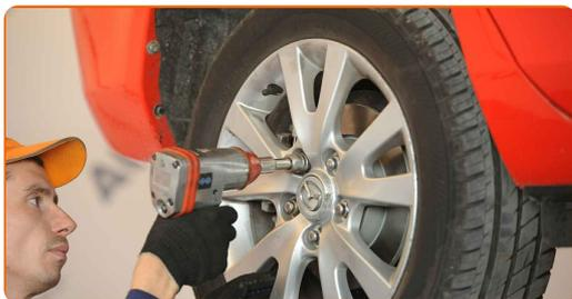
**32** Rimettere il veicolo per terra e, lavorando in ordine incrociato, serrare i bulloni di fissaggio delle ruote. Usa la chiave a bussola per dadi cerchio ruota n.19. Usa una chiave dinamometrica. Serralo fino allo coppia di torsione di 118 Nm.
