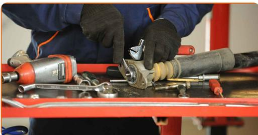
**16** Rimuovere il supporto dell'ammortizzatore, il soffietto parapolvere ed il bump stop (fine corsa).
