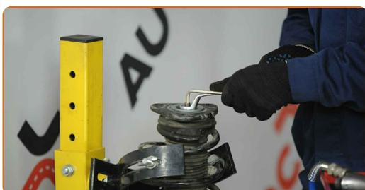
**26** Rimuovere il supporto dell'ammortizzatore, il soffietto parapolvere ed il bump stop (fine corsa).
