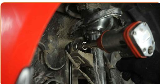
**8** Rimuovere la staffa supporto del cablaggio ABS.
