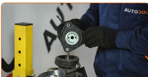
**34** Serrare la vite dell'asta pistone supporto ammortizzazione. Utilizza una chiave combinata N°19. Usa una chiave HEX N.H6. Usa una chiave dinamometrica. Serralo fino allo coppia di torsione di 60 Nm.
