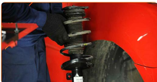
**39** Fissa gli elementi di fissaggio superiori dell'ammortizzatore (3 pezzi).
