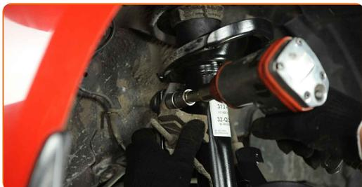
**55** Tratta con del prodotto gli elementi di fissaggio del puntone dell'ammortizzatore. Tratta con del prodotto tutti i giunti della barra stabilizzatrice. Usa il grasso al rame.
