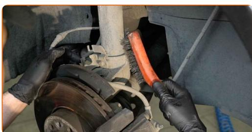
**13** Svita gli elementi di fissaggio che collegano il puntone dell'ammortizzatore al fuso a snodo. Utilizza una chiave a bussola N°17. Usa una chiave a cricchetto.
