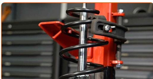
**33** Installare il supporto, il soffietto parapolvere ed il bump stop (fine corsa) su un nuovo ammortizzatore
