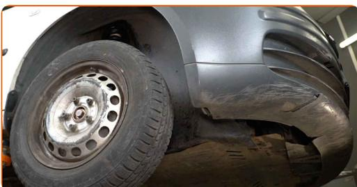
**75** Serra il bullone che collega l'albero di trasmissione al mozzo dell ruota. Utilizza una chiave a bussola N°27. Usa una chiave dinamometrica. Serralo fino allo coppia di torsione di 200 Nm. +180°
