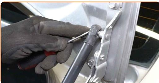
**3** Sgancia l'anello elastico che collega il puntello di supporto a gas alla carrozzeria dell'auto. Usa un giravite piatto.
