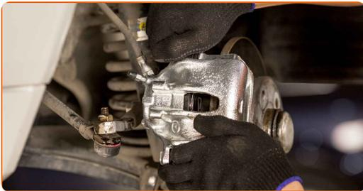
**18** Serra gli elementi di fissaggio della pinza del freno. Utilizza una chiave combinata N°15. Utilizza una chiave a bussola N°13. Usa una chiave dinamometrica. Serralo fino allo coppia di torsione di 35 Nm.
