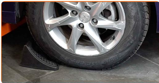
**5** Allentare i bulloni di fissaggio della ruota. Usa la chiave a bussola per dadi cerchio ruota n.17.
