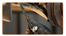
Sostituzione: testine sterzo - Skoda Fabia 6Y5. Gli esperti di AUTODOC raccomandano:
