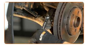
Scollegare il gambo tirante dal fuso a snodo. Usa un estrattore del giunto sferico. Usa un martello di gomma.
