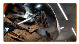
Tratta con del prodotto l'elemento di fissaggio che collega la testina tirante al fuso a snodo. Usa il grasso al rame.
