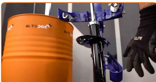
37 Installare il parapolvere e il limitatore flessione dinamica sul nuovo ammortizzatore.
