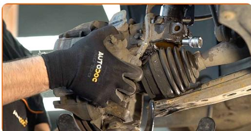
Sostituzione: ammortizzatore a molla - Skoda Fabia 6Y5. Gli esperti di AUTODOC raccomandano:
