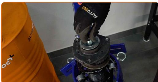
41 Serrare la vite dell'asta pistone supporto ammortizzazione. Utilizza una chiave combinata N°21. Usa una chiave HEX N.H7. Usa una chiave dinamometrica. Serralo fino allo coppia di torsione di 60 Nm.
