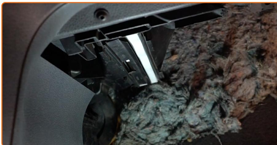
Reinstallare il coperchio della scatola filtro abitacolo. Assicurati di sentire un clic indicante che si trova installato saldamente.
